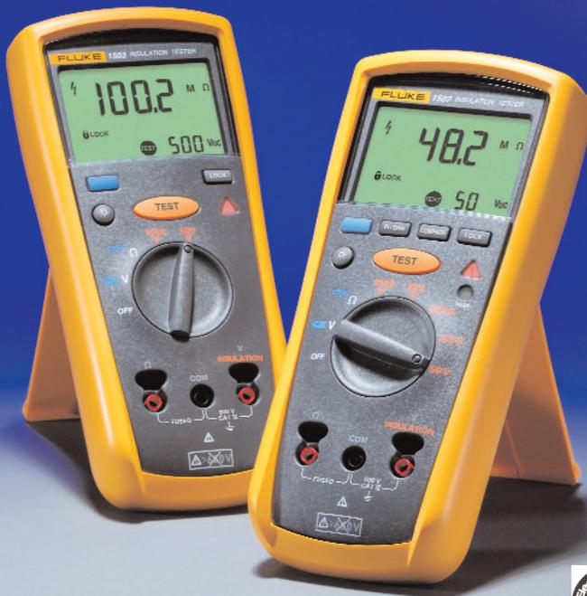
Los comprobadores de aislamiento Fluke 1507 y 1503 son compactos, robustos, confiables y sencillos de utilizar. Con sus múltiples voltajes de comprobación, son ideales para numerosas aplicaciones de localización de fallas, puesta en servicio y mantenimiento preventivo. Funciones adicionales, tales como la sonda remota de estas herramientas, ahorran tanto tiempo como dinero al efectuar ensayos.
